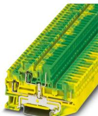
Morsetto a due piani per conduttori di terra, tipo di connessione: Connessione a molla/a innesto, sezione: 0,08 mm<sup>2</sup> - 4 mm<sup>2</sup>, tipo di montaggio: NS 35/15, NS 35/7,5, colore: giallo/verde
