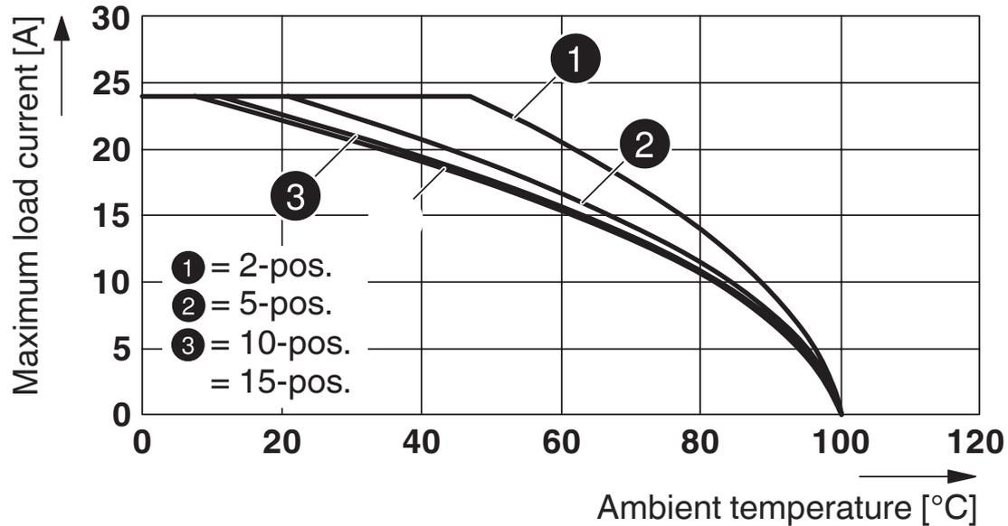
Curva derating per ST 2,5/ 1P, ST 2,5/ 2P, ST 2,5-TWIN/ 1P e per tutte le varianti di connettori SP...
