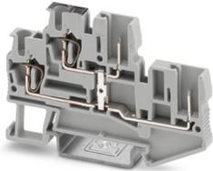
Morsetto a due piani, Corrente e tensione sono determinate dalla spina impiegata., con ripartitore di potenziale, tensione nominale: 500 V, corrente nominale: 22 A, tipo di connessione: Connessione a molla/a innesto, 1. e 2° piano, collegamento a sinistra, Sezione di dimensionamento: 2,5 mm<sup>2</sup>, sezione: 0,08 mm<sup>2</sup> - 4 mm<sup>2</sup>, 1. e 2° piano, collegamento a destra, tipo di montaggio: NS 35/15, NS 35/7,5, colore: grigio
