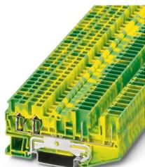
Morsetto a molla per conduttori di terra, numero di connessioni: 4, tipo di connessione: Connessione a molla/a innesto, 1. e 2° piano, collegamento a sinistra, sezione: 0,08 mm<sup>2</sup> - 4 mm<sup>2</sup>, 1. piano, collegamento a destra, tipo di montaggio: NS 35/7,5, NS 35/15, colore: giallo-verde
