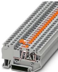
Morsetto con sezionatore a coltello, tensione nominale: 400 V, corrente nominale: 20 A, 1. piano, tipo di connessione: Connessione a molla, Sezione di dimensionamento: 4 mm<sup>2</sup>, sezione: 0,08 mm<sup>2</sup> - 6 mm<sup>2</sup>, montaggio: NS 35/7,5, NS 35/15, colore: grigio
