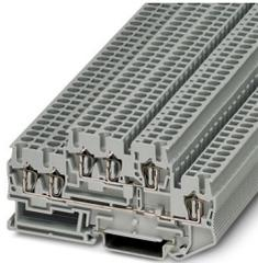
Morsetto a molla a due piani, tensione nominale: 500 V, corrente nominale: 22 A, tipo di connessione: Connessione a molla, 1. e 2. piano, Sezione di dimensionamento: 2,5 mm<sup>2</sup>, sezione: 0,08 mm<sup>2</sup> - 4 mm<sup>2</sup>, tipo di montaggio: NS 35/7,5, NS 35/15, colore: grigio
