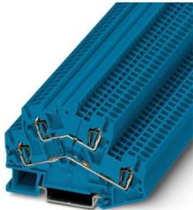
Morsetto a molla a due piani, tensione nominale: 500 V, corrente nominale: 22 A, tipo di connessione: Connessione a molla, 1. e 2. piano, Sezione di dimensionamento: 2,5 mm<sup>2</sup>, sezione: 0,08 mm<sup>2</sup> - 4 mm<sup>2</sup>, tipo di montaggio: NS 35/7,5, NS 35/15, colore: blu
