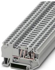
Morsetto sezionatore, Corrente e tensione sono determinate dalla spina impiegata., tensione nominale: 500 V, corrente nominale: 20 A, tipo di connessione: Connessione a molla, Sezione di dimensionamento: 4 mm<sup>2</sup>, sezione: 0,08 mm<sup>2</sup> - 6 mm<sup>2</sup>, montaggio: NS 35/7,5, NS 35/15, colore: grigio
