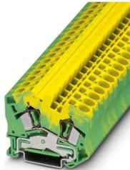
Morsetto a molla per conduttori di terra, numero di connessioni: 2, tipo di connessione: Connessione a molla, 1. piano, sezione: 0,2 mm<sup>2</sup> - 10 mm<sup>2</sup>, tipo di montaggio: NS 35/7,5, NS 35/15, colore: giallo-verde
