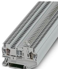
Morsetto con sezionatore a coltello, Sezionatore a coltello in grigio, tensione nominale: 400 V, corrente nominale: 20 A, tipo di connessione: Connessione a molla, Sezione di dimensionamento: 2,5 mm<sup>2</sup>, sezione: 0,08 mm<sup>2</sup> - 4 mm<sup>2</sup>, montaggio: NS 35/7,5, NS 35/15, colore: grigio
