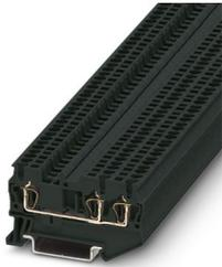
Morsetto passante, tensione nominale: 500 V, corrente nominale: 17,5 A, numero di connessioni: 3, tipo di connessione: Connessione a molla, Sezione di dimensionamento: 1,5 mm<sup>2</sup>, sezione: 0,08 mm<sup>2</sup> - 1,5 mm<sup>2</sup>, tipo di montaggio: NS 35/7,5, NS 35/15, colore: nero
