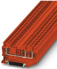
Morsetto passante, tensione nominale: 500 V, corrente nominale: 17,5 A, numero di connessioni: 3, tipo di connessione: Connessione a molla, Sezione di dimensionamento: 1,5 mm<sup>2</sup>, sezione: 0,08 mm<sup>2</sup> - 1,5 mm<sup>2</sup>, tipo di montaggio: NS 35/7,5, NS 35/15, colore: rosso
