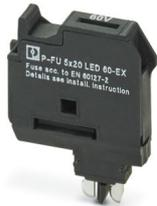
Spina portafusibile, Prima di sostituire il fusibile G, estrarre la spina portafusibile dal morsetto base., tensione nominale: 500 V, corrente nominale: 6,3 A, tipo fusibile: G / 5 x 20, colore: nero
