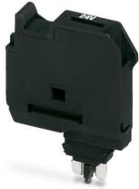
Spina portafusibile, Prima di sostituire il fusibile G, estrarre la spina portafusibile dal morsetto base., tensione nominale: 500 V, corrente nominale: 6,3 A, tipo di connessione: Attacco connettore, tipo fusibile: G / 5 x 20, tipo di montaggio: Montaggio a innesto, colore: nero
