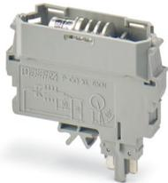
Spina porta componenti, pensato per l'alloggiamento del diodo SKN 2,5, tensione nominale: 400 V, corrente nominale: 1,25 A, tipo di connessione: Attacco connettore, profondità: 37,5 mm, larghezza: 12,3 mm, altezza: 41,2 mm, numero poli: 1, colore: grigio, tipo di montaggio: a innesto (Slot)
