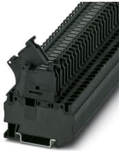
Morsetto portafusibili, tipo di fusibile: Vetro / ceramica / ..., tipo fusibile: G / 5 x 20, tensione nominale: 250 V, corrente nominale: 6,3 A, tipo di connessione: Connessione a molla, 1. piano, Sezione di dimensionamento: 1 mm<sup>2</sup>, sezione: 0,08 mm<sup>2</sup>- 6 mm<sup>2</sup>, tipo di montaggio: NS 35/7,5, NS 35/15, colore: nero
