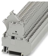
Morsetto portafusibili, tipo di fusibile: Vetro / ceramica / ..., tipo fusibile: G / 5 x 20, tensione nominale: 24 V, corrente nominale: 6,3 A, tipo di connessione: Connessione a molla, 1. piano, Sezione di dimensionamento: 1 mm<sup>2</sup>, sezione: 0,08 mm<sup>2</sup>- 6 mm<sup>2</sup>, tipo di montaggio: NS 35/7,5, NS 35/15, colore: grigio
