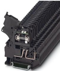
Morsetto portafusibili, tipo di fusibile: Vetro / ceramica / ..., tipo fusibile: G / 5 x 20, tensione nominale: 24 V, corrente nominale: 6,3 A, tipo di connessione: Connessione a molla, 1. piano, Sezione di dimensionamento: 1 mm<sup>2</sup>, sezione: 0,08 mm<sup>2</sup>- 6 mm<sup>2</sup>, tipo di montaggio: NS 35/7,5, NS 35/15, colore: nero
