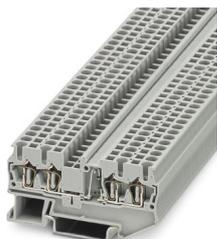
Componente morsetto componibile, con diodo integrato, tensione nominale: 800 V, corrente nominale: 0,5 A, tipo di connessione: Connessione a molla, Sezione di dimensionamento: 1 mm<sup>2</sup>, sezione: 0,08 mm<sup>2</sup> - 4 mm<sup>2</sup>, montaggio: NS 35/7,5, NS 35/15, colore: grigio
