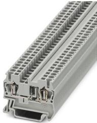
Componente morsetto componibile, con diodo integrato 1N4007, corrente nominale: 0,5 A, tipo di connessione: Connessione a molla, Sezione di dimensionamento: 2,5 mm<sup>2</sup>, sezione: 0,08 mm<sup>2</sup> - 4 mm<sup>2</sup>, montaggio: NS 35/7,5, NS 35/15, colore: grigio
