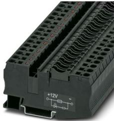
Morsetto portafusibili con LED per il montaggio su NS 35, per interruttori di protezione, spessore morsetto: 8,2 mm, colore: nero
