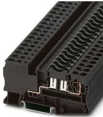
Morsetto portafusibili, tipo di fusibile: Piatta, tipo fusibile: C, tensione nominale: 400 V, corrente nominale: 30 A, tipo di connessione: Connessione a molla, 1. piano, Sezione di dimensionamento: 4 mm<sup>2</sup>, sezione: 0,08 mm<sup>2</sup>- 6 mm<sup>2</sup>, tipo di montaggio: NS 35/7,5, NS 35/15, colore: nero
