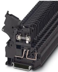
Morsetto portafusibili, tipo di fusibile: Vetro / ceramica / ..., tipo fusibile: G / 5 x 20, tensione nominale: 500 V, corrente nominale: 6,3 A, tipo di connessione: Connessione a molla, Sezione di dimensionamento: 4 mm<sup>2</sup>, sezione: 0,08 mm<sup>2</sup>- 6 mm<sup>2</sup>, tipo di montaggio: NS 35/7,5, NS 35/15, colore: nero
