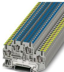
Morsetto a due piani per conduttori di terra, tensione nominale: 500 V, corrente nominale: 22 A, tipo di connessione: Connessione a molla, 1. e 2. piano, Sezione di dimensionamento: 2,5 mm<sup>2</sup>, sezione: 0,08 mm<sup>2</sup> - 4 mm<sup>2</sup>, tipo di montaggio: NS 35/7,5, NS 35/15, colore: grigio
