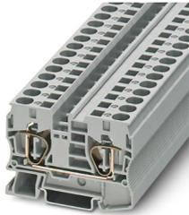
Morsetto passante, tensione nominale: 1000 V, corrente nominale: 57 A, numero di connessioni: 2, tipo di connessione: Connessione a molla, Sezione di dimensionamento: 10 mm<sup>2</sup>, sezione: 0,2 mm<sup>2</sup> - 16 mm<sup>2</sup>, tipo di montaggio: NS 35/7,5, NS 35/15, colore: grigio
