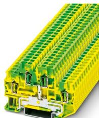
Morsetto a due piani per conduttori di terra, numero di connessioni: 4, tipo di connessione: Connessione a molla, sezione:  $0,08 \text{ mm}^2 - 4 \text{ mm}^2$ , tipo di montaggio: NS 35/7,5, NS 35/15, colore: giallo-verde
