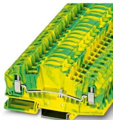
Morsetti comp. per conduttori terra, numero di connessioni: 2, tipo di connessione: Connessione a vite, sezione:  $0,2 \text{ mm}^2$  -  $10 \text{ mm}^2$ , tipo di montaggio: NS 35/7,5, NS 35/15, colore: giallo-verde
