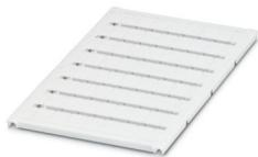
Segnamorsetti, Scheda, bianco, in bianco, siglabile con: BLUEMARK E.CARD, BLUEMARK ID COLOR, BLUEMARK ID, BLUEMARK CLED, PLOTMARK, CMS-P1-PLOTTER, tipo di montaggio: bloccaggio, per morsetti con spessore: 8,2 mm, Numero dei cartellini singoli: 56, altezza del campo di testo: 10,5 mm, larghezza del campo di testo: 7,6 mm
