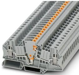
Morsetto sezionatore per conv. misura, tensione nominale: 500 V, corrente nominale: 30 A, 1. piano, tipo di connessione: Connessione a vite, Sezione di dimensionamento: 6 mm<sup>2</sup>, sezione: 0,2 mm<sup>2</sup> - 10 mm<sup>2</sup>, montaggio: NS 35/7,5, NS 35/15, colore: grigio
