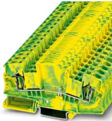
Morsetti comp. per conduttori terra, numero di connessioni: 2, tipo di connessione: Connessione a molla, sezione: 0,2 mm<sup>2</sup> - 10 mm<sup>2</sup>, tipo di montaggio: NS 35/7,5, NS 35/15, colore: giallo-verde
