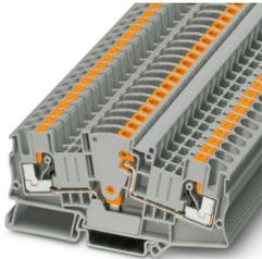
Morsetto sezionatore per conv. misura, tensione nominale: 1000 V, corrente nominale: 30 A, numero di connessioni: 2, tipo di connessione: Connessione Push-in, 1. piano, Sezione di dimensionamento: 6 mm<sup>2</sup>, sezione: 0,5 mm<sup>2</sup> - 10 mm<sup>2</sup>, tipo di montaggio: NS 35/15, NS 35/7,5, colore: grigio
