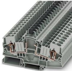
Componente morsetto componibile, Se sulla guida di supporto vengono affiancati più morsetti a diodi è necessario inserire una piastrina distanziatrice., con diodo integrato P1000M, tensione nominale: 1000 V, corrente nominale: 5 A, tipo di connessione: Connessione a molla, Sezione di dimensionamento: 6 mm<sup>2</sup>, sezione: 0,2 mm<sup>2</sup> - 10 mm<sup>2</sup>, colore: grigio
