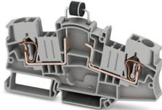
Componente morsetto componibile, Se sulla guida di supporto vengono affiancati più morsetti a diodi è necessario inserire una piastrina distanziatrice., con diodo integrato P1000M, tensione nominale: 1000 V, corrente nominale: 5 A, tipo di connessione: Connessione a molla, Sezione di dimensionamento: 6 mm<sup>2</sup>, sezione: 0,2 mm<sup>2</sup> - 10 mm<sup>2</sup>, colore: grigio
