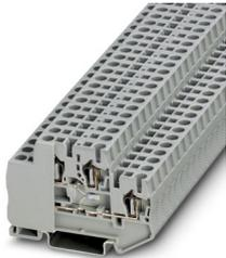
Morsetto a molla a due piani, con sonda termica, tipo di connessione: Connessione a molla, 1. e 2. piano, Sezione di dimensionamento: 2,5 mm<sup>2</sup>, sezione: 0,08 mm<sup>2</sup> - 4 mm<sup>2</sup>, tipo di montaggio: NS 35/7,5, NS 35/15, colore: grigio
