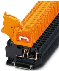
Morsetti sezionatori con leva, tensione nominale: 500 V, corrente nominale: 20 A, tipo di connessione: Connessione a molla, Sezione di dimensionamento: 4 mm<sup>2</sup>, sezione: 0,08 mm<sup>2</sup> - 6 mm<sup>2</sup>, montaggio: NS 35/7,5, NS 35/15, colore: nero/arancio
