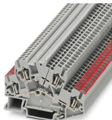
Componente morsetto componibile, con diodo integrato, corrente nominale: 0,5 A, 1. e 2. piano, tipo di connessione: Connessione a molla, Sezione di dimensionamento: 2,5 mm<sup>2</sup>, sezione: 0,08 mm<sup>2</sup> - 4 mm<sup>2</sup>, montaggio: NS 35/7,5, NS 35/15, colore: grigio
