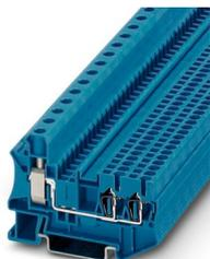
Morsetto ripartitore di potenziale, tensione nominale: 800 V, corrente nominale: 55 A, tipo di connessione: Connessione a vite, Sezione di dimensionamento: 10 mm<sup>2</sup>, sezione: 0,5 mm<sup>2</sup> - 16 mm<sup>2</sup>, tipo di connessione: Connessione a molla, Sezione di dimensionamento: 2,5 mm<sup>2</sup>, sezione: 0,08 mm<sup>2</sup> - 4 mm<sup>2</sup>, montaggio: NS 35/7,5, NS 35/15, colore: blu
