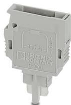
Spina porta componenti, con diodo 1N4007, profondità: 33,3 mm, larghezza: 5,2 mm, altezza: 24,2 mm, numero poli: 1, colore: grigio, tipo di montaggio: Montaggio a innesto
