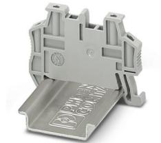
Supporto terminale a montaggio rapido, classe di combustibilità V0 secondo UL 94, per guida di supporto NS 35/7,5 o NS 35/15, siglabile con UC-TM 5, UC-TMF 5, KLM 2, KLM3 e KML3L, possibilità di posizionamento per FBS...5, FBS...6, KSS 5, KSS 6, larghezza: 5,15 mm, colore: grigio
