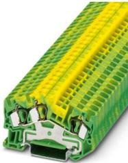
Morsetti comp. per conduttori terra, numero di connessioni: 3, tipo di connessione: Connessione a molla, 1. piano, sezione: 0,08 mm<sup>2</sup> - 6 mm<sup>2</sup>, tipo di montaggio: NS 35/7,5, NS 35/15, colore: giallo-verde
