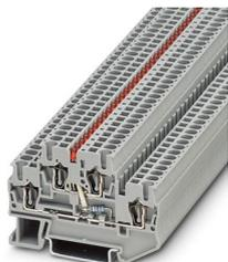
Componente morsetto componibile, tensione nominale: 250 V, corrente nominale: 22 A, 1. e 2. piano, tipo di connessione: Connessione a molla, Sezione di dimensionamento: 2,5 mm<sup>2</sup>, sezione: 0,08 mm<sup>2</sup> - 4 mm<sup>2</sup>, montaggio: NS 35/7,5, NS 35/15, colore: grigio
