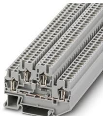
Componente morsetto componibile, La corrente massima è determinata dal diodo. Integrato: diodo 1N 4007, tensione di blocco: 1300V, corrente limite permanente: 0,5A., con diodo integrato 1N4007, corrente nominale: 0,5 A, 1. e 2. piano, tipo di connessione: Connessione a molla, Sezione di dimensionamento: 2,5 mm<sup>2</sup>, sezione: 0,08 mm<sup>2</sup> - 4 mm<sup>2</sup>, montaggio: NS 35/7,5, NS 35/15, colore: grigio
