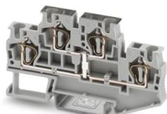
Morsetto a due piani, con ripartitore di potenziale, tensione nominale: 500 V, corrente nominale: 30 A, tipo di connessione: Connessione a molla, 1. e 2. piano, Sezione di dimensionamento: 4 mm<sup>2</sup>, sezione: 0,08 mm<sup>2</sup> - 6 mm<sup>2</sup>, tipo di montaggio: NS 35/7,5, NS 35/15, colore: grigio
