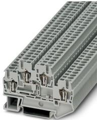
Morsetto a molla a due piani, tensione nominale: 500 V, corrente nominale: 22 A, tipo di connessione: Connessione a molla, Sezione di dimensionamento: 2,5 mm<sup>2</sup>, sezione: 0,08 mm<sup>2</sup> - 4 mm<sup>2</sup>, tipo di montaggio: NS 35/7,5, NS 35/15, colore: grigio
