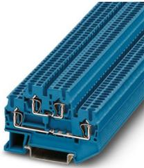
Morsetto a molla a due piani, tensione nominale: 500 V, corrente nominale: 17,5 A, tipo di connessione: Connessione a molla, 1. e 2. piano, Sezione di dimensionamento: 1,5 mm<sup>2</sup>, sezione: 0,08 mm<sup>2</sup> - 1,5 mm<sup>2</sup>, tipo di montaggio: NS 35/7,5, NS 35/15, colore: blu
