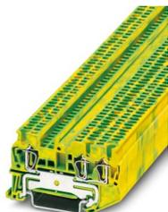
Morsetti comp. per conduttori terra, numero di connessioni: 3, tipo di connessione: Connessione a molla, 1. piano, sezione:  $0,08 \text{ mm}^2 - 1,5 \text{ mm}^2$ , tipo di montaggio: NS 35/7,5, NS 35/15, colore: giallo-verde
