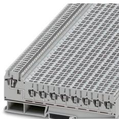
Ripartitore di potenziale, tensione nominale: 500 V, corrente nominale: 24 A, tipo di connessione: Connessione a molla, 1. Piano attacco sinistra, Sezione di dimensionamento: 2,5 mm<sup>2</sup>, sezione: 0,14 mm<sup>2</sup> - 4 mm<sup>2</sup>, tipo di connessione: Connessione a molla, 1. piano, collegamento a destra, Sezione di dimensionamento: 1,5 mm<sup>2</sup>, sezione: 0,14 mm<sup>2</sup> - 2,5 mm<sup>2</sup>, montaggio: NS 35/7,5, NS 35/15, colore: grigio
