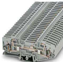
Morsetto sezionatore per conv. misura, con blocchetto scorrevole, tensione nominale: 400 V, corrente nominale: 41 A, 1. piano, tipo di connessione: Connessione a molla, Sezione di dimensionamento: 6 mm<sup>2</sup>, sezione: 0,2 mm<sup>2</sup> - 10 mm<sup>2</sup>, montaggio: NS 35/7,5, NS 35/15, colore: grigio
