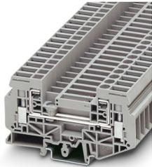
Morsetto passante, tensione nominale: 500 V, corrente nominale: 41 A, tipo di connessione: Connessione a vite, 1. piano, Sezione di dimensionamento: 6 mm<sup>2</sup>, sezione: 0,5 mm<sup>2</sup> - 10 mm<sup>2</sup>, tipo di montaggio: NS 35/7,5, NS 35/15, NS 32, colore: grigio
