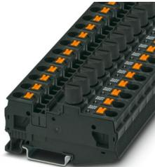
Morsetto portafusibili, tipo di fusibile: Vetro / ceramica / ..., tipo fusibile: G / 5 x 20, tensione nominale: 24 V, corrente nominale: 10 A, tipo di connessione: Connessione Push-in, Sezione di dimensionamento: 6 mm<sup>2</sup>, sezione: 0,5 mm<sup>2</sup>- 10 mm<sup>2</sup>, tipo di montaggio: NS 35/7,5, NS 35/15, colore: nero
