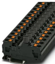
Morsetto portafusibili, tipo di fusibile: Vetro / ceramica / ..., tipo fusibile: G / 5 x 20, tensione nominale: 1000 V, corrente nominale: 10 A, tipo di connessione: Connessione Push-in, Sezione di dimensionamento: 6 mm<sup>2</sup>, sezione: 0,5 mm<sup>2</sup>- 10 mm<sup>2</sup>, tipo di montaggio: NS 35/7,5, NS 35/15, colore: nero
